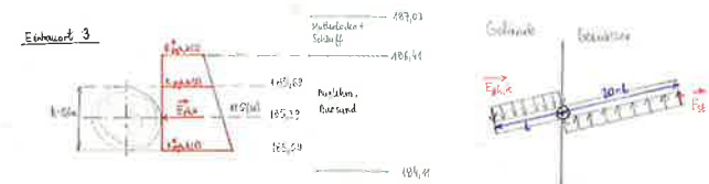
Abb. 9: Schematische Darstellung der Einwirkungen und Widerstände beim Nachweis der Einbindetiefe (Quelle: BCE Erfurt)
